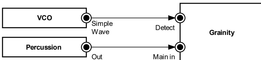
2. Stellen Sie die Granular Engine so ein, dass sie nur dann einen Step weiterschaltet, wenn der Percussion-Sound ausgelöst wird. Das gelingt ziemlich einfach: Verbinden Sie das Triggersignal für den Sound zusätzlich mit dem Detect-Eingang.
